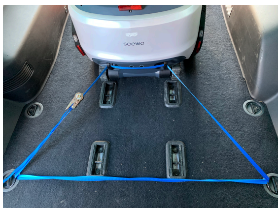
(c) Fixation du fauteuil roulant à l'arrière
