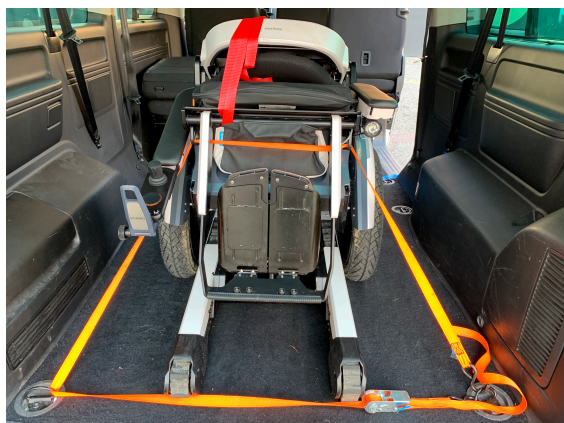
(a) Fixation du fauteuil roulant à l'avant
