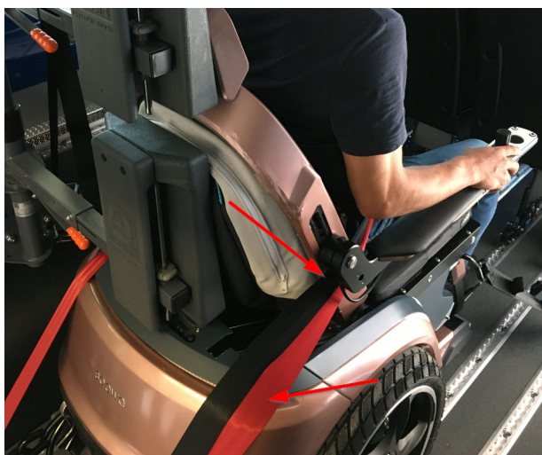
Figure 71. Attache correcte de la ceinture pelvienne (rouge) et de la ceinture de retenue à 3 points (noire) pour sécuriser l'occupant
