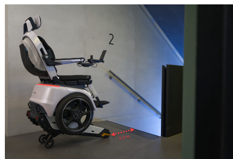
Figure 50. N'activez le mode conduite ou escalier que lorsqu'une distance minimale de 50 cm par rapport au bord de l'escalier est respectée.
