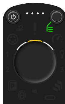
(b) Le moteur de levage du siège ne peut pas être réglé en mode escalier.
