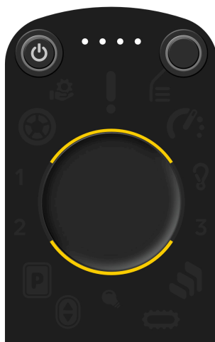
Figure 44. Le panneau de commande indique que le joystick doit être avancé ou reculé
