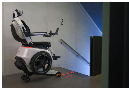
Figure 52. N'activez le mode conduite ou escalier que lorsqu'une distance minimale de 50 cm par rapport au bord de l'escalier est respectée.
