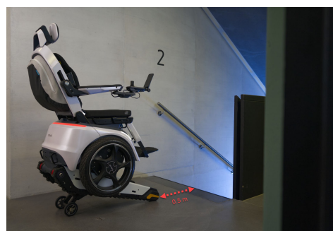
Figure 55. N'activez le mode conduite ou escalier que lorsqu'une distance minimale de 50 cm par rapport au bord de l'escalier est respectée.
