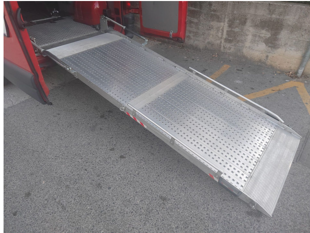
Figure 69. Rampe pliante dangereuse et raide avec seuil en haut
