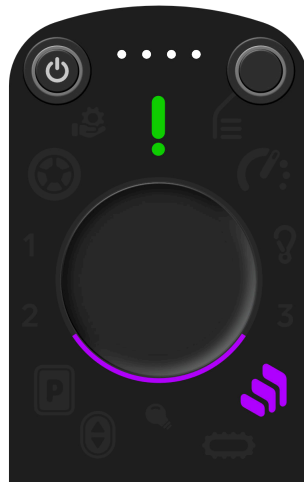
Figure 56. L'indicateur d'information vert indique que la fin de l'escalier a été détectée et que le système de support a été étendu. Lorsque vous continuez à avancer, l'indicateur d'information vert disparaît. Vous êtes désormais suffisamment éloigné des escaliers et pouvez passer en mode conduite.
